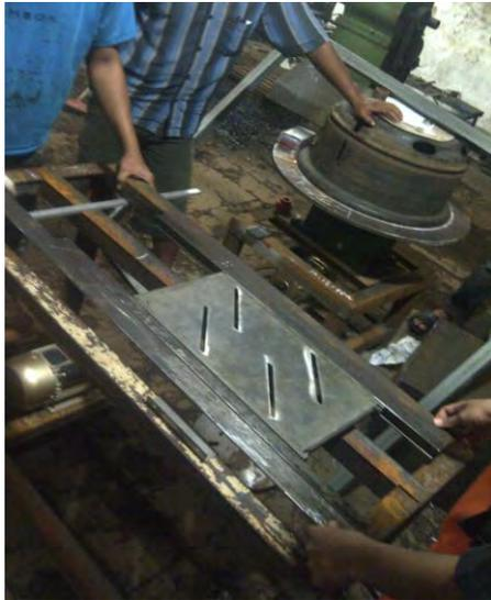
**Setting untuk menyesuaikan papan pisau dengan rangka mesin**
