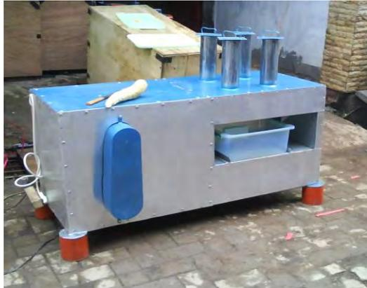
**Gambar 2.4** Mesin pemotong singkong dengan 4 hopper
