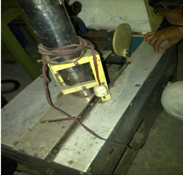
**Mesin menggunakan system pemotongan secara horizontal dan menggunakan satu hopper**
