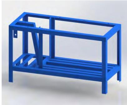
**Gambar 3.2** Sket rangka mesin pemotong singkong
