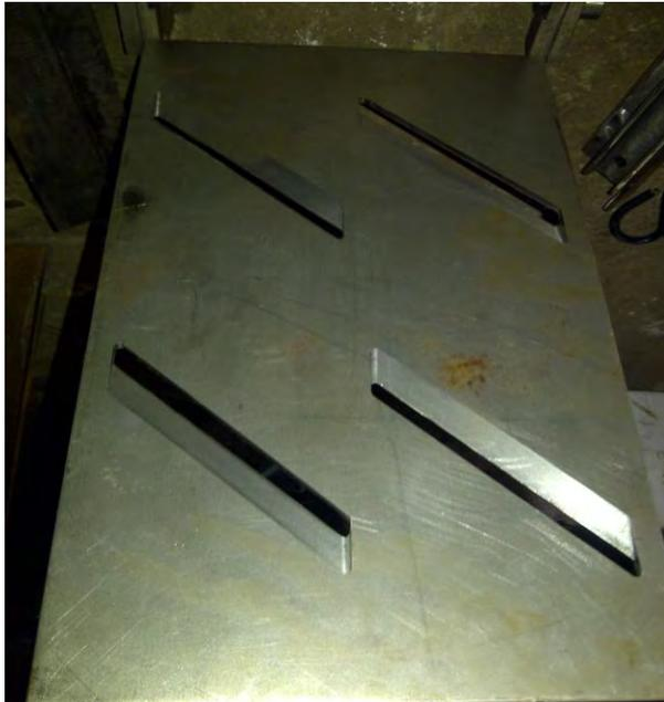
**Papan pisau stainless yang telah dilakukan proses machining**
