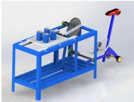
**Gambar 3.4** Hasil pembuatan mesin pemotong singkong
