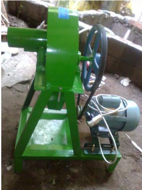
**Gambar 2.3** Mesin pemotong singkong dengan motor
