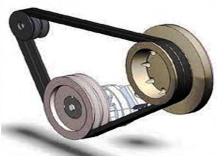
Gambar 2.5.(c). (Drivetrain pully dan V-belt yang digunakan pada mobil - gerandong)
