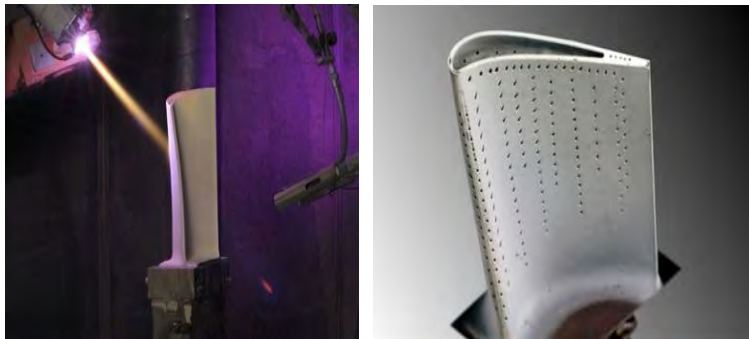
Gambar 2.17 Metode Pendinginan Film Cooling (a) Proses pembuatan Insulating Layer pada Blade (b) Insulating layer pada blade turbin
