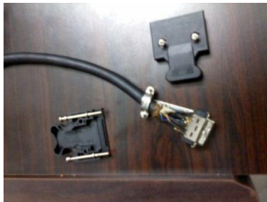
Gambar 4.30 Konektor CN2 setelah disolder
