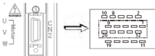
Gambar 4.28 CN2 dengan 20 Pin
