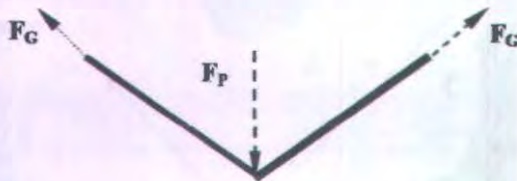
Gambar 5. 8 Gambar Permukaan Emboosing dan Distribusi Gaya Pada Proses Embossing
