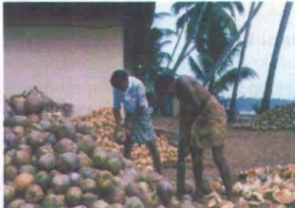
Gambar 2.1 Pengupasan dengan slumbat
