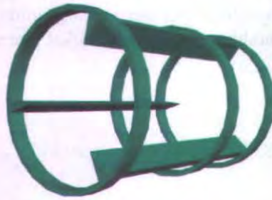
Gambar 5.10 Kerangka penyusun drum screener
