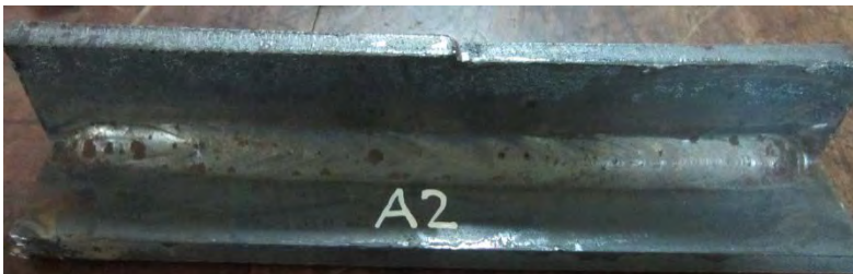
Gambar B 3. Hasil las spesimen A2
