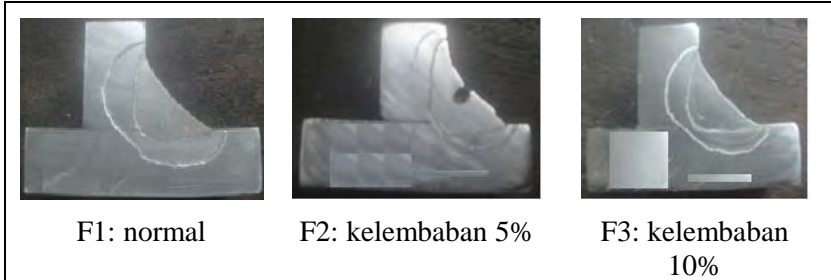
Gambar 4. 3. Hasil etsa makro penampang lasan percobaan dengan kelembaban flux yang berbeda
