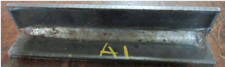
Gambar B 2. Hasil las spesimen A1
