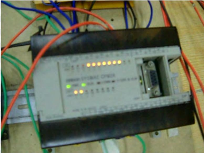
**Gambar 4.8** Indikator *Input* PLC Saat Semua Sensor Terkena Air
