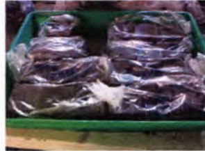
Gambar 3.9. Curing mortar geopolimer dengan cara ditutup plastik
