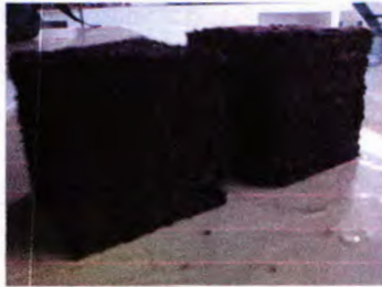
Gambar 4.19. Hasil campuran mortar trial mix 1 yang telah dicetak
