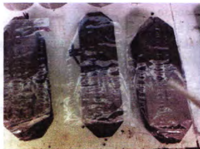
Gambar 3.7 Pencetakan mortar geopolimer
