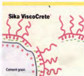
Gambar 2.8. Mekanisme kerja Polycarboxylic
