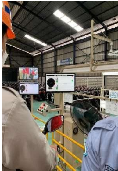
Melakukan Dyno Test pada motor Gesist
