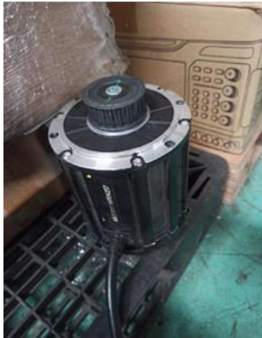
Gambar 4. 18 BLDC yang digunakan pada motor GESITS
