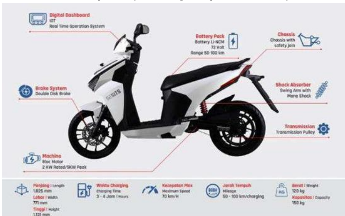
Gambar 2. 5 Spesifikasi Motor GESITS (Sumber : Dokumen Perusahaan)
