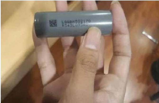
Gambar 4. 11 Baterai cell pada motor GESITS G1
