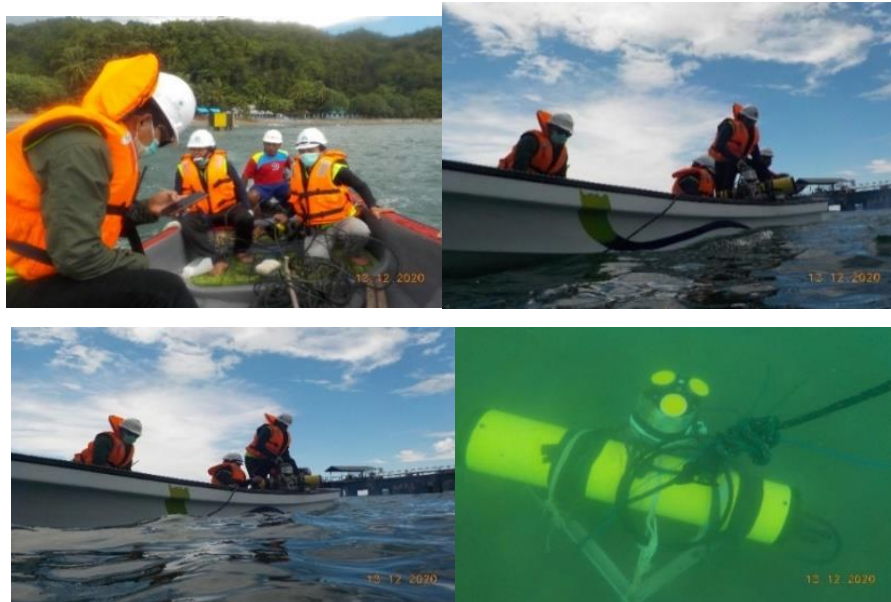
Gambar 3.5. Proses Pemasangan Alat Ukur Arus Puslantek COT-Unhas (2020)
