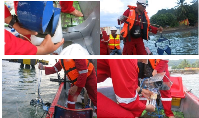
Gambar 3.8. Proses Pengambilan Sampel Sedimen Dasar dan Melayang Puslantek COT-Unhas (2020)
