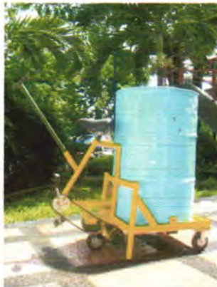
Gambar 5.6 Mesin Pengaduk Kotoran Sapi hasil Assembly
