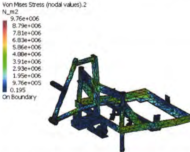
Gambar 4.38. Tegangan Von Mises Maksimum dan Minimum Yang Terjadi pada Rangka Mesin Pengaduk
