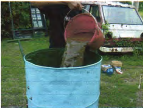
Gambar 6.2 Proses penuangan campuran kotoran sapi ke mesin pengaduk
