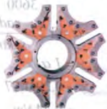
Gambar 4.39 Bintang segienam sebagai mekanisme penggerak dudukan cetakan
