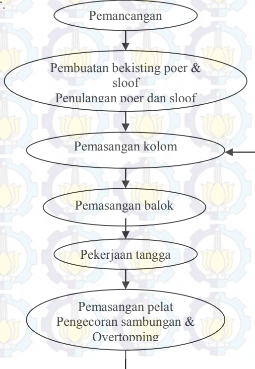
Gambar 10.2 Proses Pemancangan Elemen Beton Pracetak
