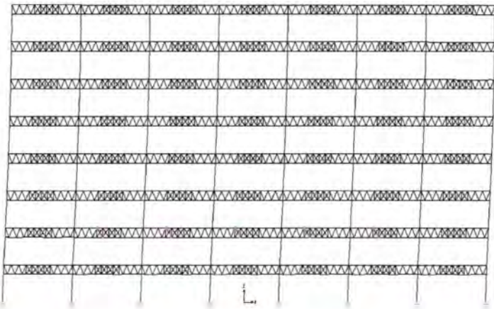
Gambar 6.4 Leleh terakhir pada gedung dengan segmen Khusus 5m
