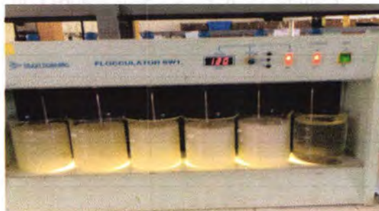
Gambar D.24. Jar Test Limbah Asli Dengan \text{CaCO}_3 Kecepatan 120 RPM
