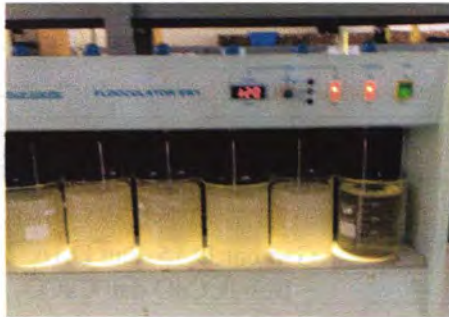
Gambar D.20. Jar Test Limbah Asli Dengan \text{Ca}(\text{OH})_2 Kecepatan 120 RPM
