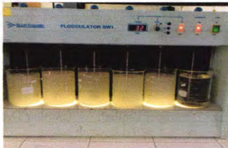
Gambar D.21. Jar Test Limbah Asli Dengan \text{Ca}(\text{OH})_2 Kecepatan 30 RPM
