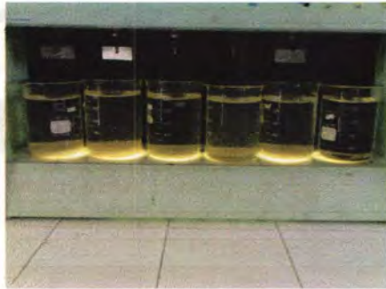
Gambar D.22. Proses Sedimentasi Limbah Asli Dengan \text{Ca}(\text{OH})_2
