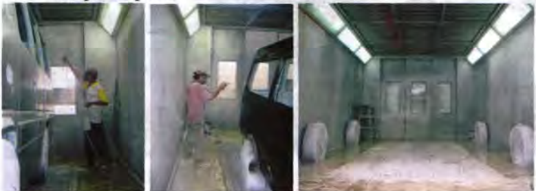
Gambar 2.10 Kendaraan mengalami proses pengecatan dasar primer (kiri), proses painting (tengah), dan ruang oven (kanan)
