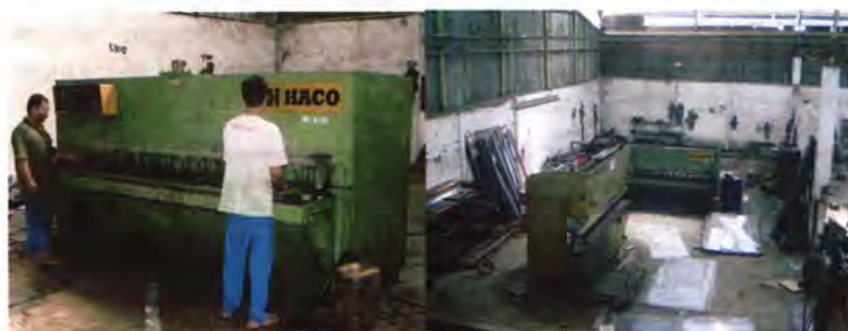
Gambar 2.4. proses pemotongan plat baja yang akan dibentuk menjadi komponen sub-assy (kiri), mesin pembentukan komponen sub-assy (kanan)
