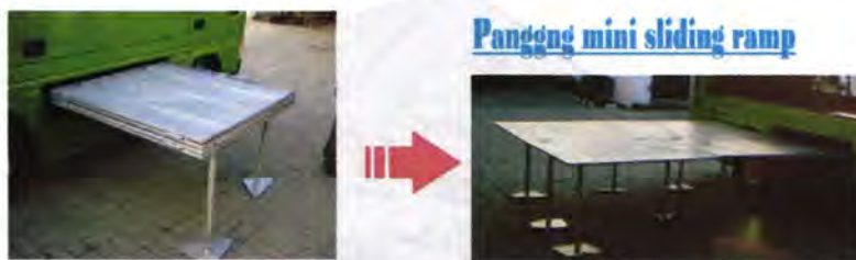
Gambar 4.38. Sliding ramp dan aplikasinya
