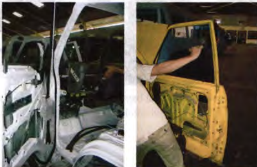
Gambar 2.3. Proses strip off pada kendaraan
