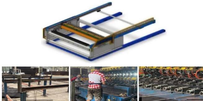
**Gambar 4.28** 3D Desain Manual Feeding Longitudinal Wire, Keranjang Batang Baja
