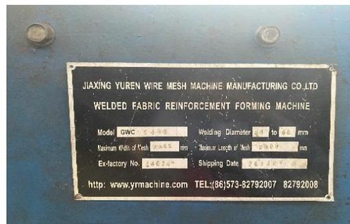
**Gambar 4.26** Name Plate dan Spesifikasi Welded Fabric Reinforcement Forming Machine di PT PIW
