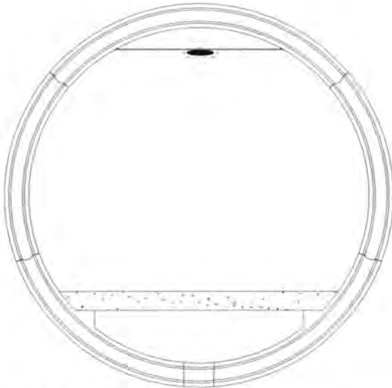
Gambar 4.4: Rencana penampang melintang terowongan dengan TBM
