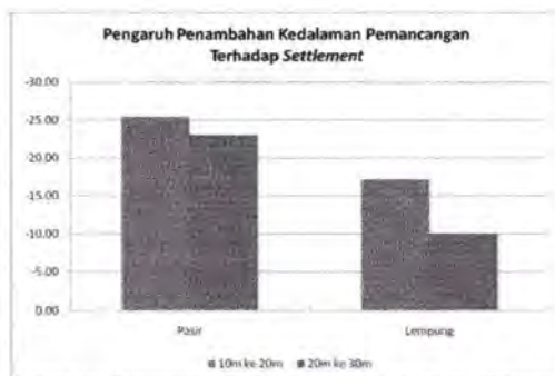
Gambar 5.118 Pengaruh Penambahan Kedalaman Pemancangan Terhadap Settlement
