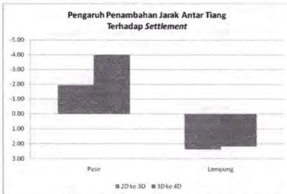
Gambar 5.119 Pengaruh Penambahan Jarak Antar Tiang Terhadap Settlement
