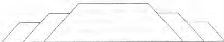
Gambar 2.7 Pemberian preloading secara counter weight
