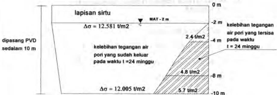
Gambar 5.11 Kelebihan tegangan air pori pada lapisan tanah STA 9+775
