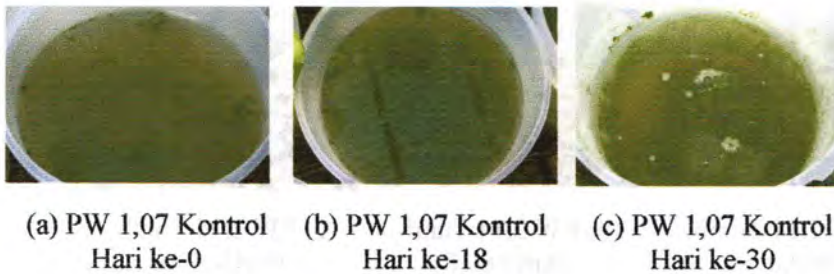
Gambar 4.56 Hasil Pengamatan Reaktor Kontrol Limbah Industri Phenolic Water 1,07 mg/L pada Hari ke-0, 18 dan 30
