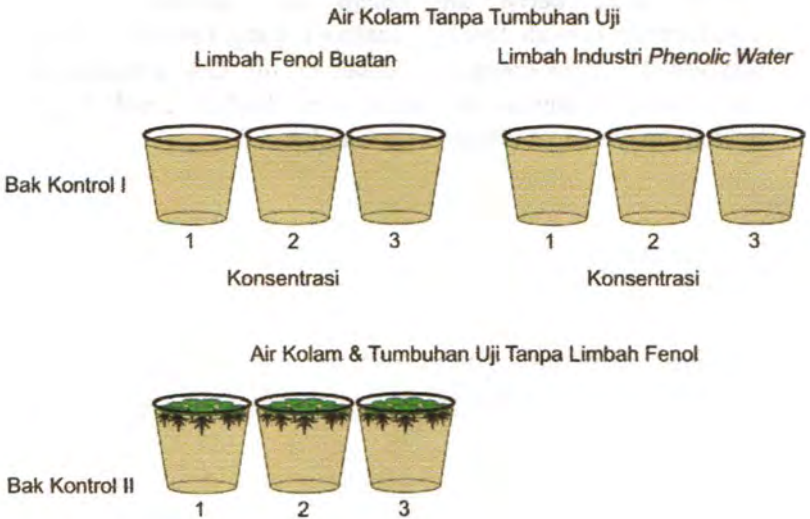
Gambar 3.3 Susunan Reaktor Penelitian
