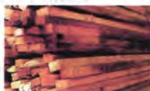
Gambar 2.24. Kayu reng untuk rangka plafon
