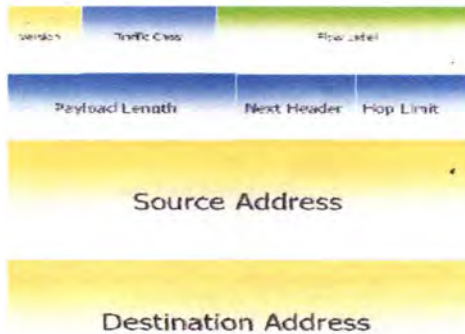
Gambar 1. Struktur Header pada IPv6
