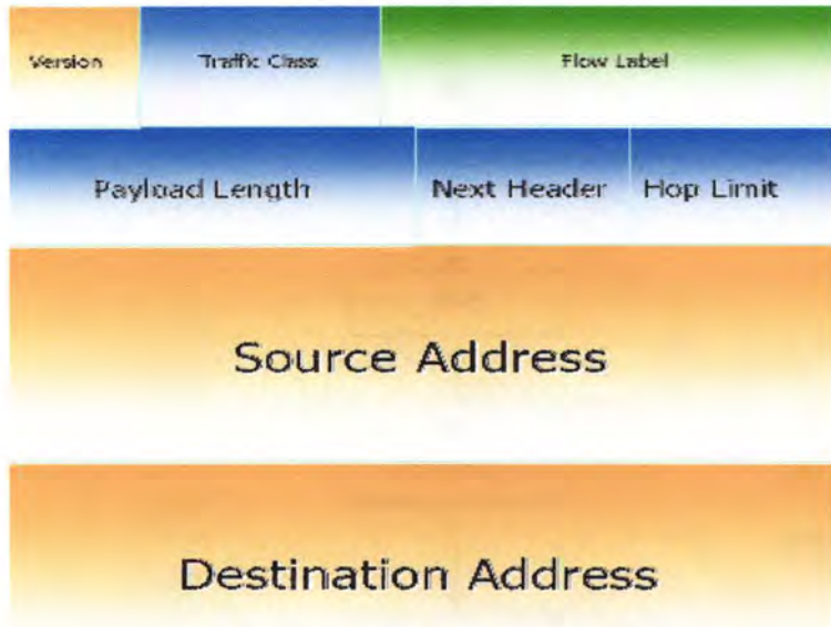
Gambar 2.2. Susunan header IPv6
