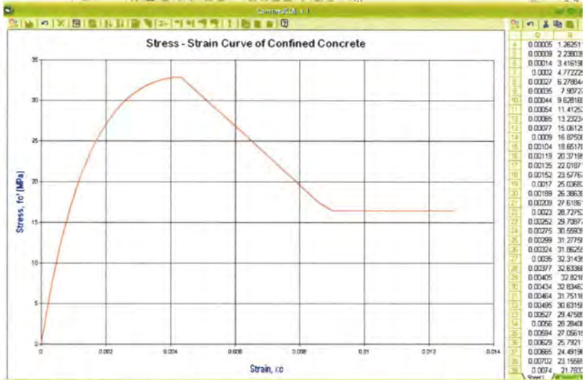
Gambar 5.40 ConfinedCOL v.1 : kurva tegangan-regangan beton terkekang, metode confined Kusuma-Tavio (Kasus 5)
