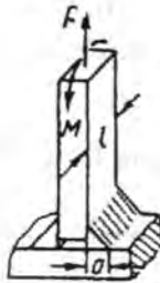
Gambar 2.9 Sambungan tee dengan beban F dan momen
