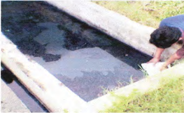
Gambar 2.2 Bak Pengumpul Limbah dan Lokasi Pengambilan Sampel
