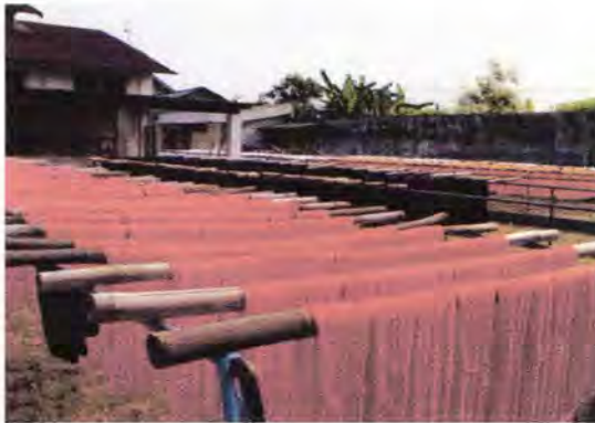
Gambar 2.1 Proses Pengeringan Benang
