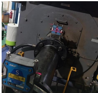
Gambar 4.20 Proses Alignment Shaft (Sumber: Dokumentasi Pribadi 2024)
