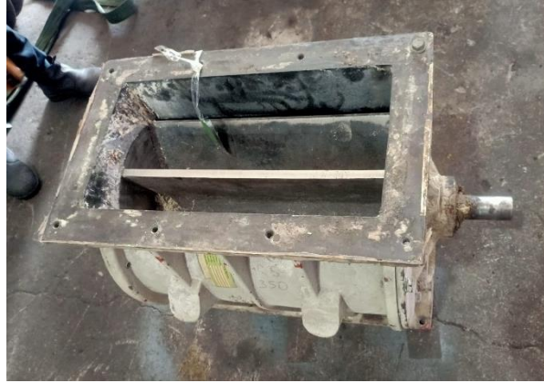
Gambar 5.11 Kondisi Awal Rotary Valve Tipe RS 35 Saat Tiba di Workshop (Sumber: Dokumentasi Pribadi 2024)
