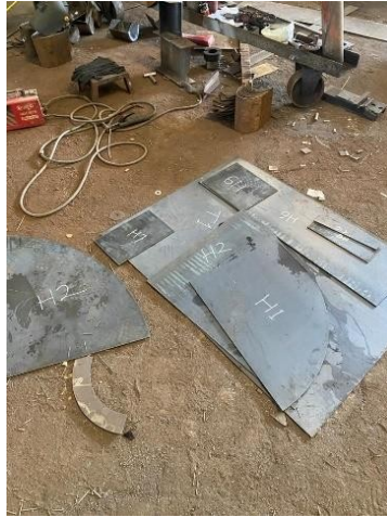
Gambar 4.10 Proses Marking atau Penandaan Pada Plat Besi yang Telah Dipotong (Sumber : Dokumentasi Pribadi)
