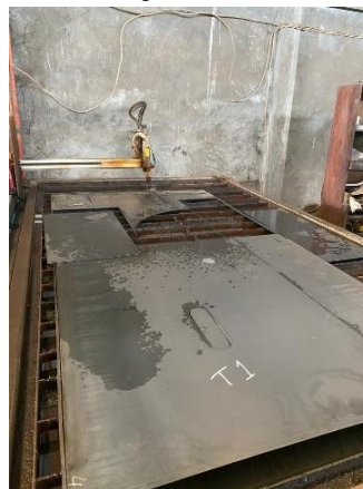
Gambar 4.9 Proses Pemotongan (Cutting) Plat Bagian Casing Elevator (Sumber : Dokumentasi Pribadi)
