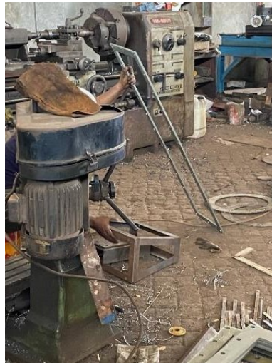
Gambar 4.11 Proses Pengeboran ( Drilling ) Pada Flange Bucket Elevator (Sumber : Dokumentasi Pribadi)
