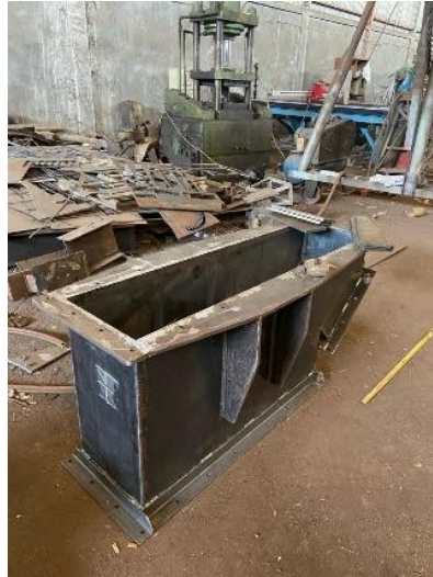
Gambar 5.12 Proses Assembly Bagian Head Bucket Elevator (Sumber : Dokumentasi Pribadi)
