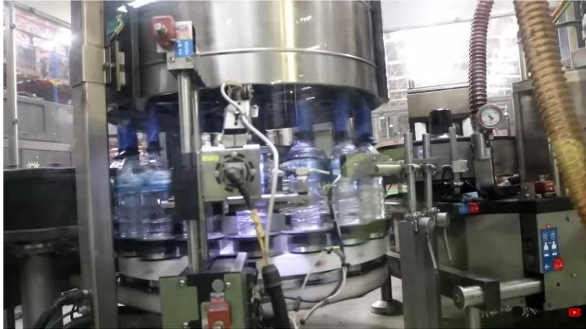
**Gambar 4. 8** Proses Labelling pada Botol
