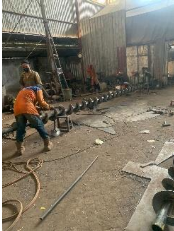
Gambar 4. 23 Proses Pembuatan Screw Conveyor
