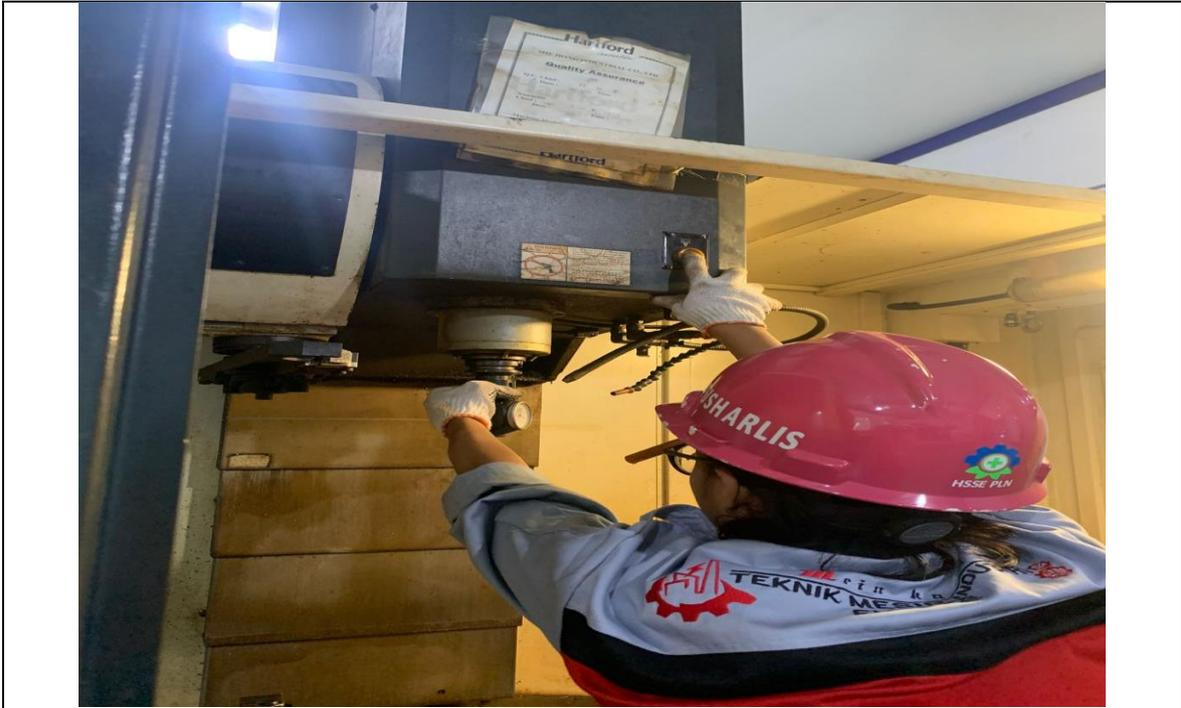
Setting Arbor pada Mesin CNC Milling
