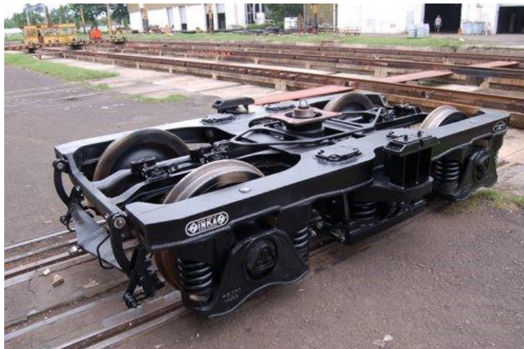
Gambar 4. 9 Bogie TB-398 yang termasuk tipe K-5
