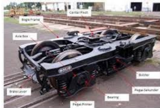
Gambar 4.5 Konstruksi Bogie Kereta Penumpang dengan Bolster
