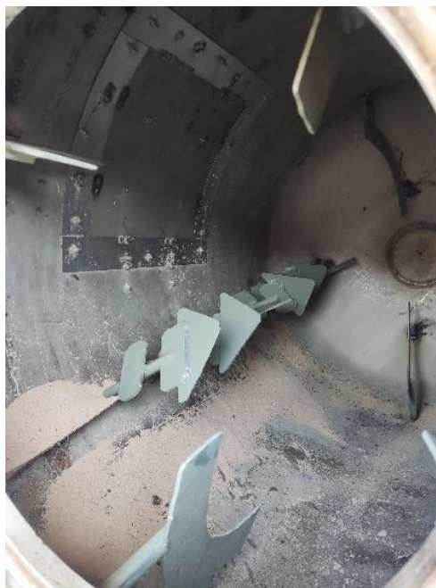
Gambar 4. 17 Pengetesan Mixer dengan Pengaduk Jenis Paddle
