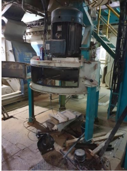
Gambar 4. 13 Pembongkaran Hammer Mill untuk Penggantian Sieve dan Blade
