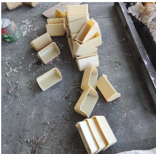
Gambar 4. 20 Bucket yang Akan Dipasang pada Belt
