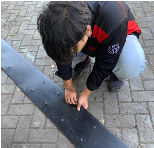
Gambar 4. 19 Pemasangan Baut untuk Bucket pada Belt
