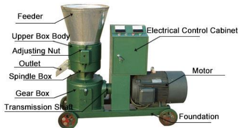
Gambar 4.30 Flat Die Pellet Mill
