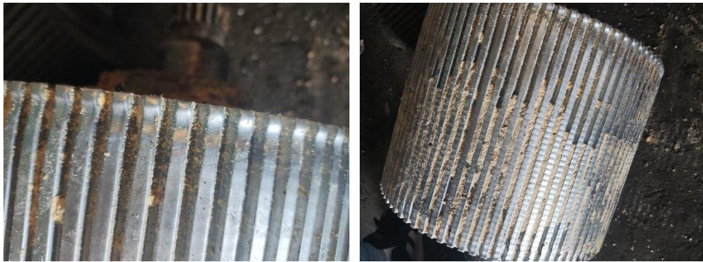
Gambar 4.40 Roller yang Sudah Aus
