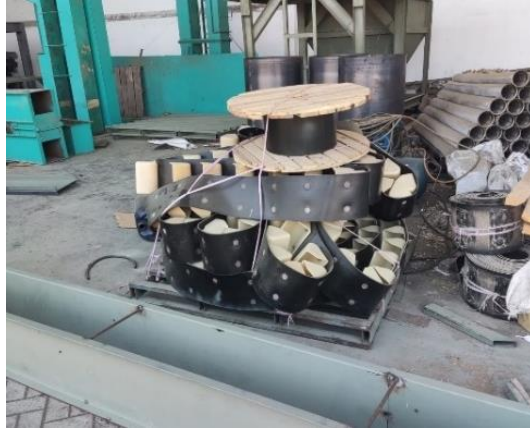
Gambar 4. 21 Belt yang Sudah Terpasang Bucket
