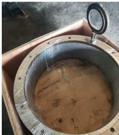
Gambar 4.42 Suku Cadang Ring Die Pellet Mill
