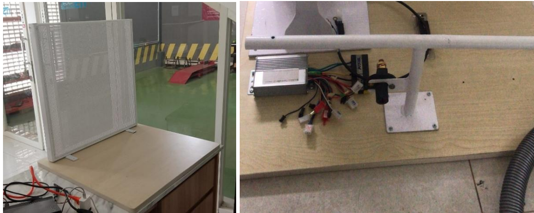
Gambar 4. 19 Mounting rangkaian Low Voltage (Kiri), dan Mounting stir (Kanan)
