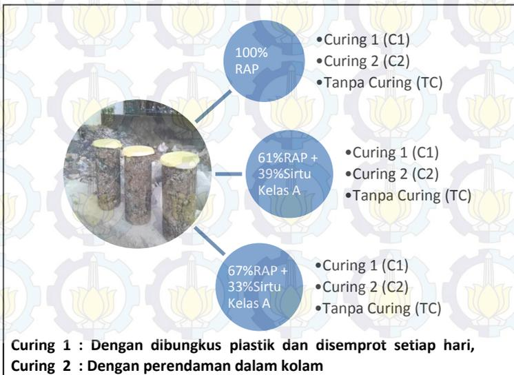
Gambar 4.8 : Skema Variasi Benda Uji
