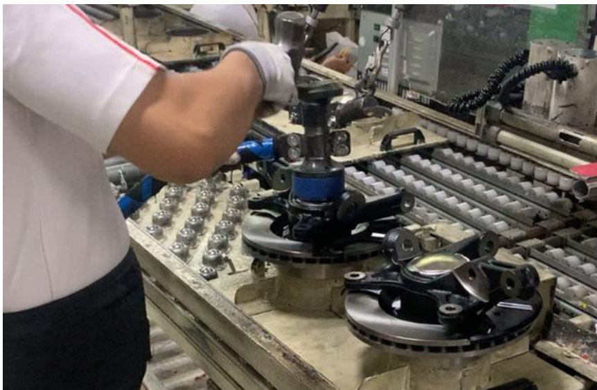
Gambar 4. 4 Proses Pemasangan Cap menggunakan Palu & Special Tool
