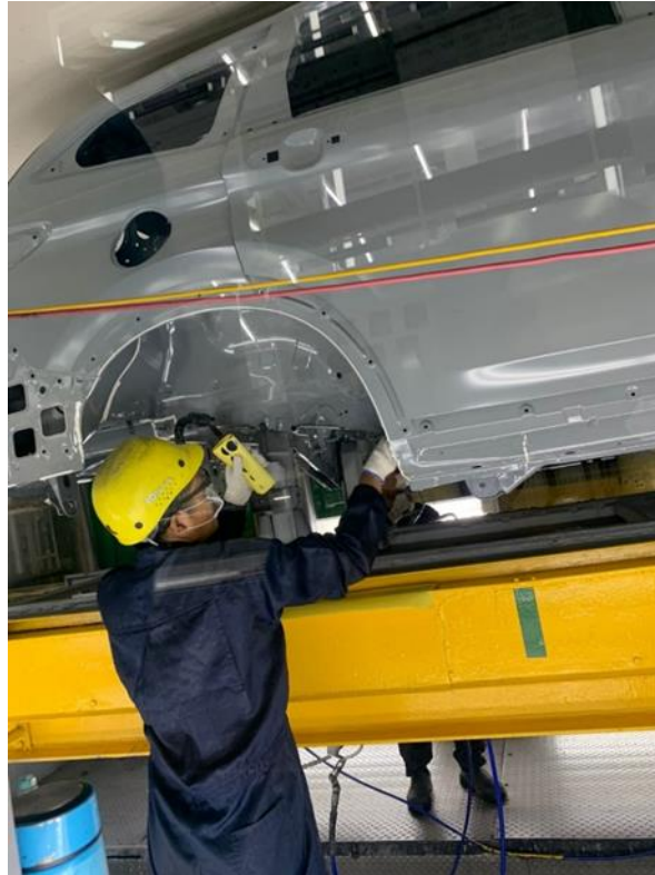
Gambar 3. 7 Proses Pemberian Terotec pada Bagian Under Body
