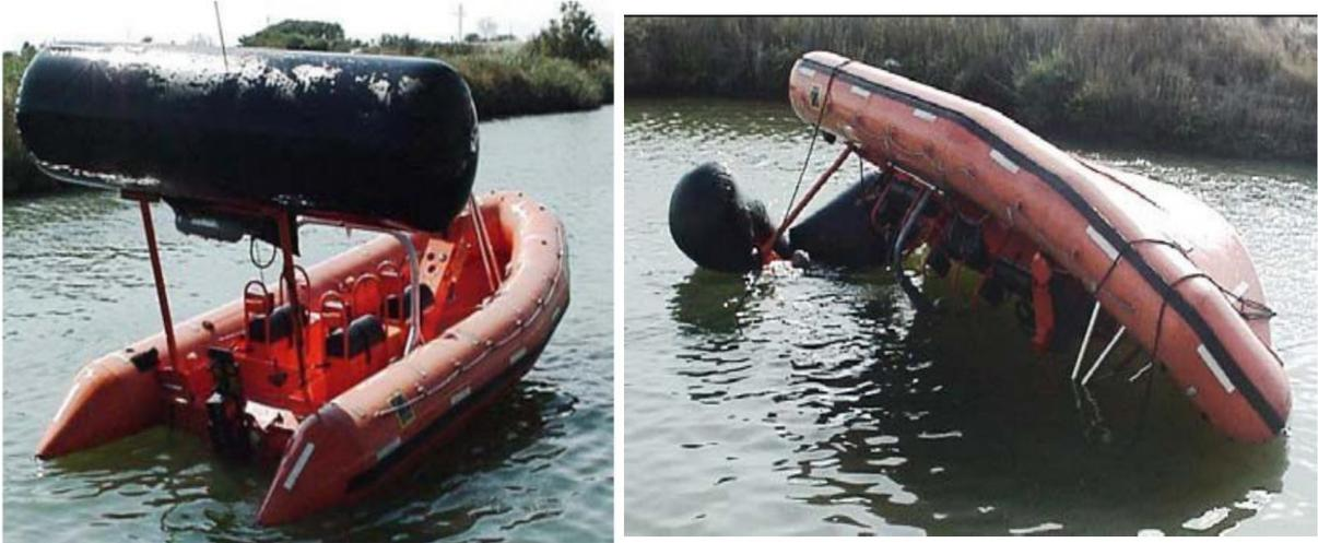
Gambar 2.21 *Rigid Inflatable Boats* pada kapal kelas SIGMA(Schelde Naval Shipbuilding, 2007)
