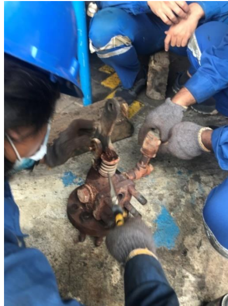
Memperbaiki poppet valve pada sootblower IR
