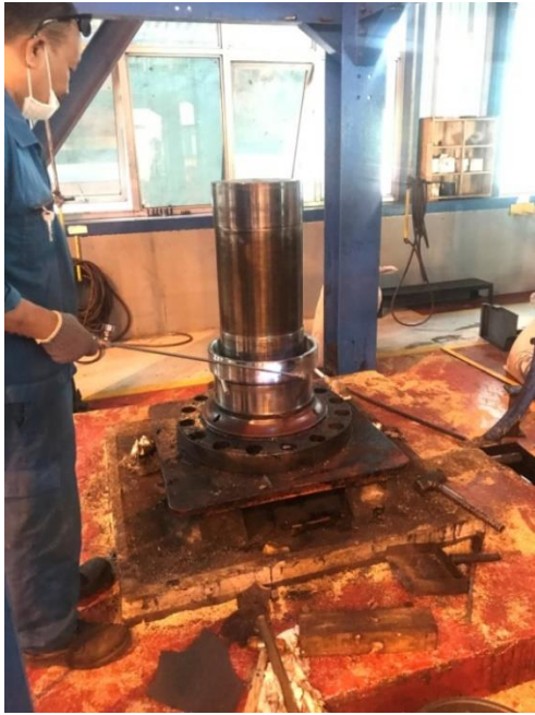
Pelepasan komponen grinding mill pada pulvulizer
