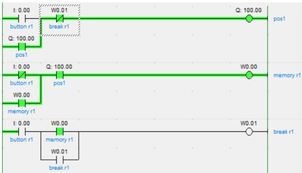
Gambar 4.22 logic saat push button ditekan 1x
