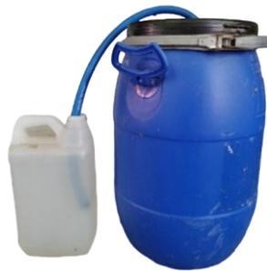
**Gambar 3.2** Drum dengan selang air untuk mencegah ledakan selama fermentasi anaerob.
