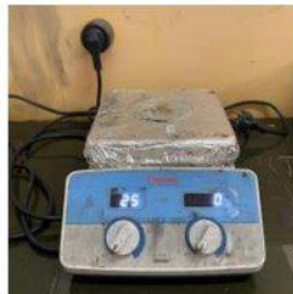
Gambar 3. 8 Magnetic Stirrer (Dokumentasi Pribadi)
