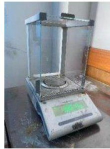
Gambar 3. 9 Neraca Analitik (Dokumentasi Pribadi)
