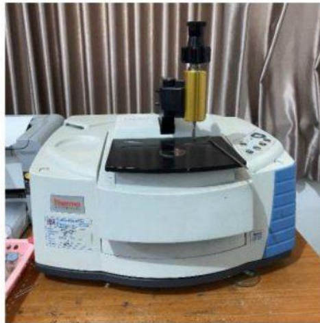
Gambar 3. 12 Alat FTIR (Dokumentasi Pribadi)
