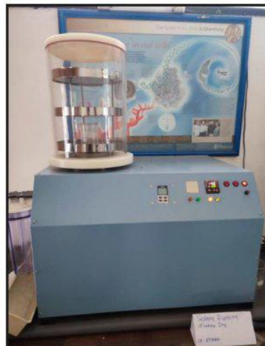
Gambar 3. 11 Freeze Dryer (Dokumentasi Pribadi)
