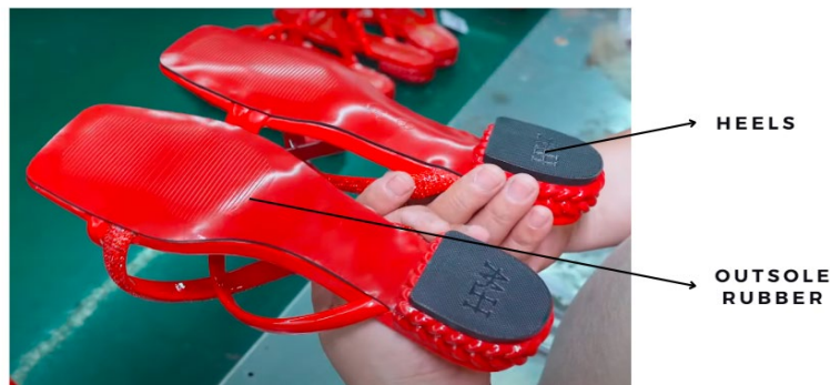
Gambar 2. 4 Komponen Outsole dengan Heels (Sumber: Olahan Penulis, 2024)
