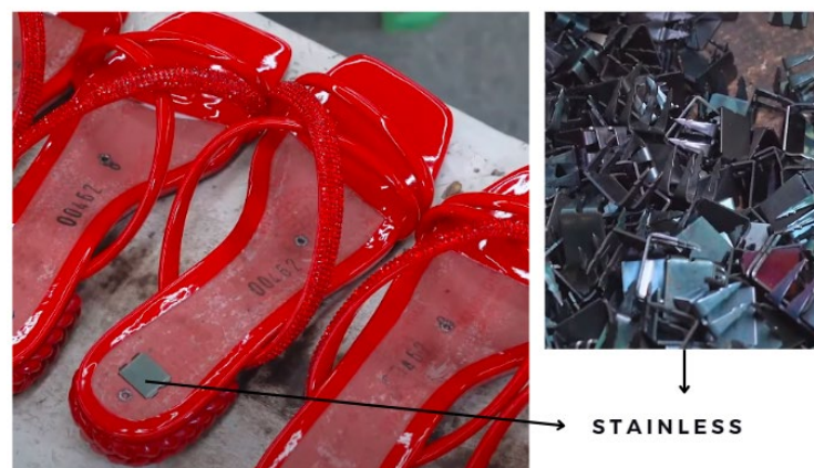
Gambar 4. 3 Komponen Outsole dengan Heels (Sumber: Olahan Penulis, 2024)
