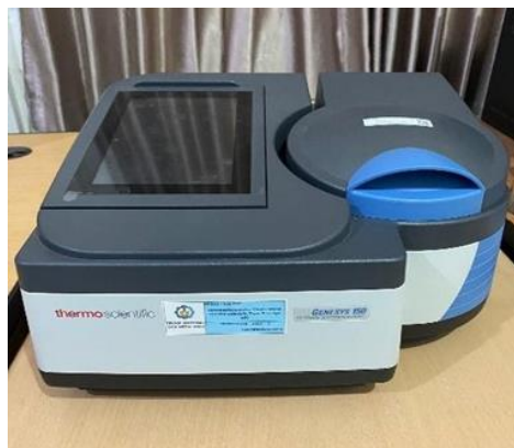
Gambar 3.20 Instrumen UV-Vis Genesys 10S UV-Vis Spectrometer
