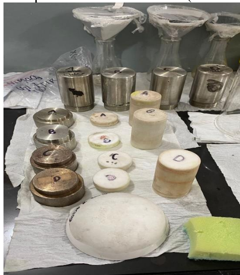
Gambar 2.21 Contoh autoclave yang digunakan proses hidrotermal (Dokumen Pribadi)
