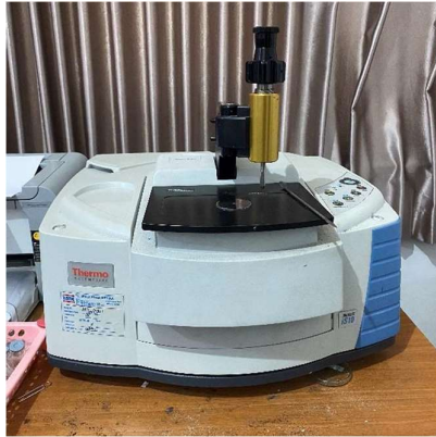
Gambar 3.7 Instrumen FTIR (dokumentasi pribadi)
