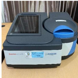
Gambar 3.10 Instrumentasi UV-Vis (dokumentasi pribadi)
