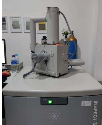
Gambar 3.5 Alat uji SEM-EDX (dokumentasi pribadi)
