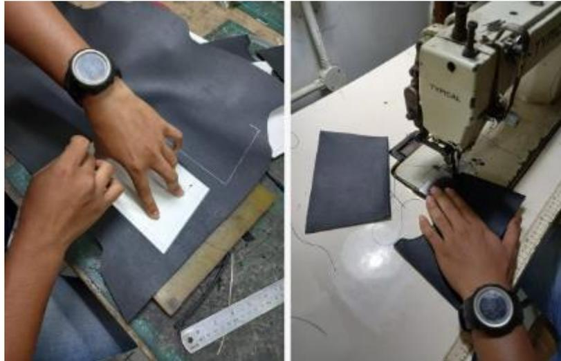
Gambar 5. 12 Proses pembuatan pola potong dan jahit pada *leather*
