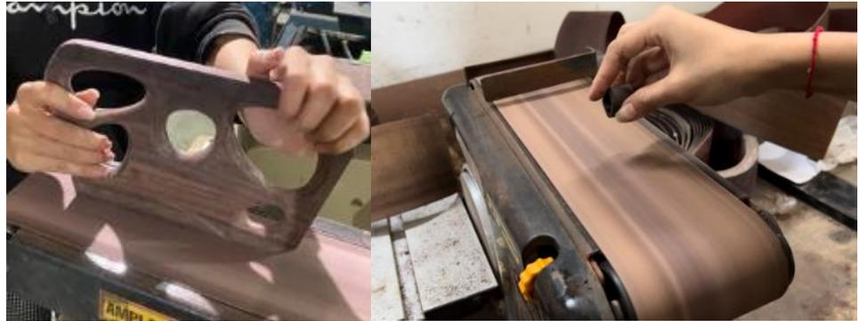
Gambar 5. 10 Proses finishing kayu dengan amplas belt sander
