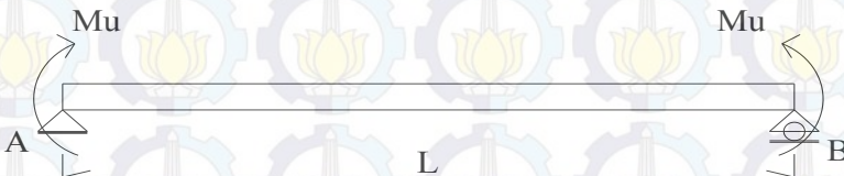
Gambar 7.3 Gaya Yang Bekerja Pada Balok
