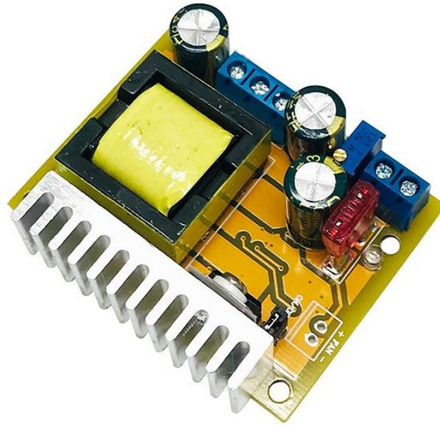
Gambar 4 31 DC-DC Flyback (sumber: buku dasar-dasar teknik elektronika kementerian pendidikan, kebudayaan, riset, dan teknologi 2022)
