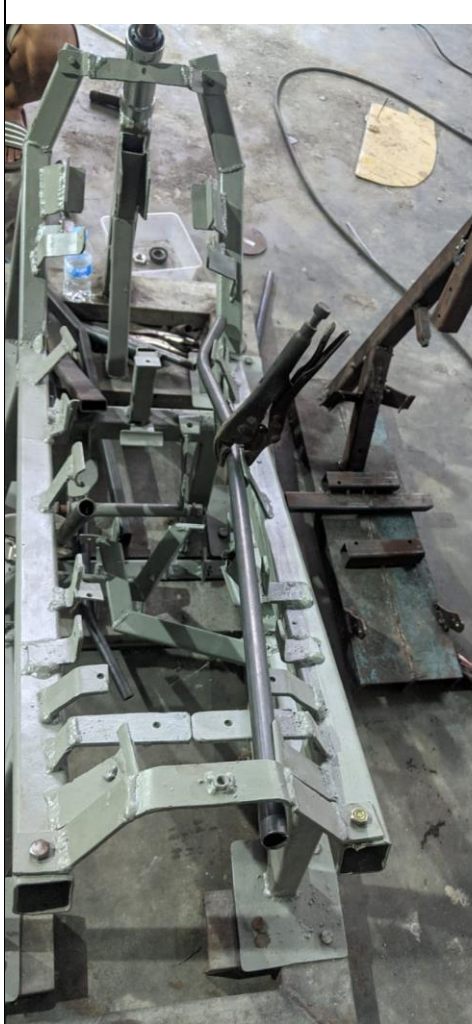
Proses pengelasan untuk membuat chassis E-Scrambler
