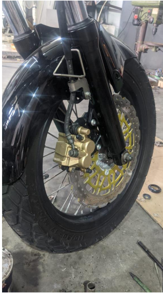
Pemasangan roda depan setelah memasang shock
