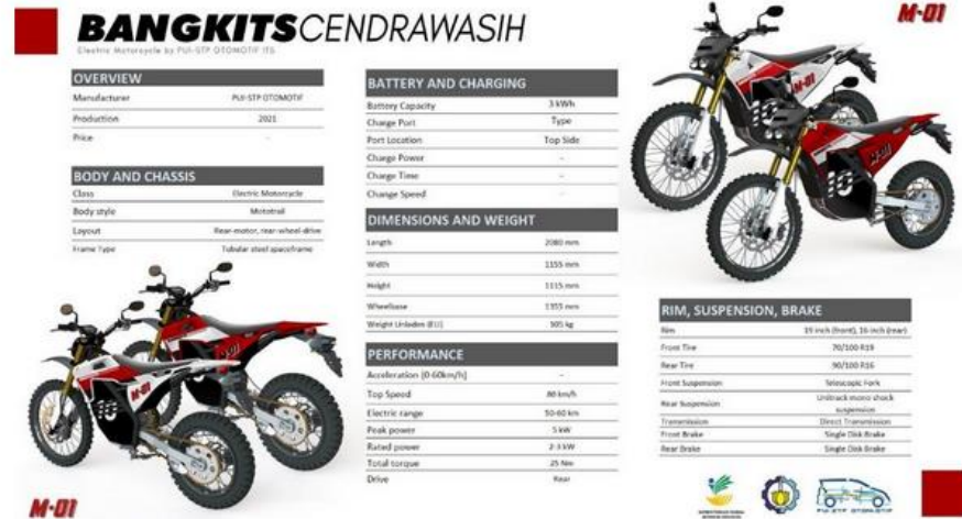
Gambar 2 3 Spesifikasi Prototype E-Trail BANGKITS Cendrawasih M.01 (Sumber: Drive STP ITS)
