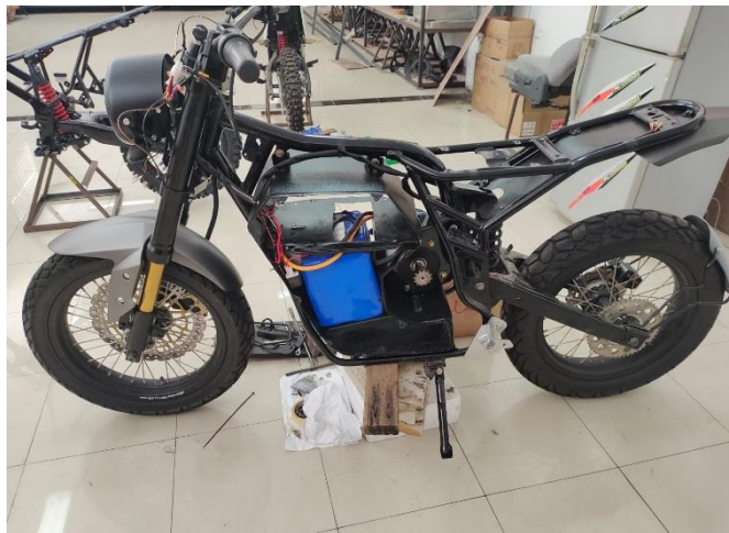
pemasangan wiring setelah tahap menjadikan rolling chassis untuk kemudian di uji kinerja motor, battery dan can controller
