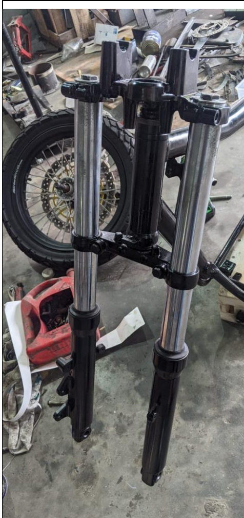
Pemasangan shock depan pada E-Scrambler
