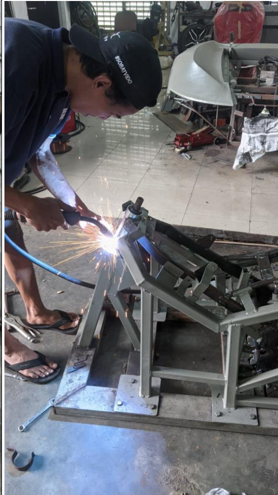
Proses pengelasan untuk membuat chassis
