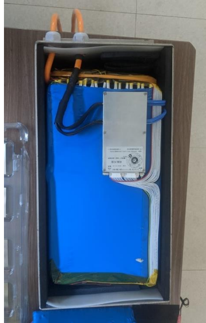
Battery pack yang digunakan pada kendaraan roda 3 pengangkut sampah dan kendaraan roda 3 toko sayur
