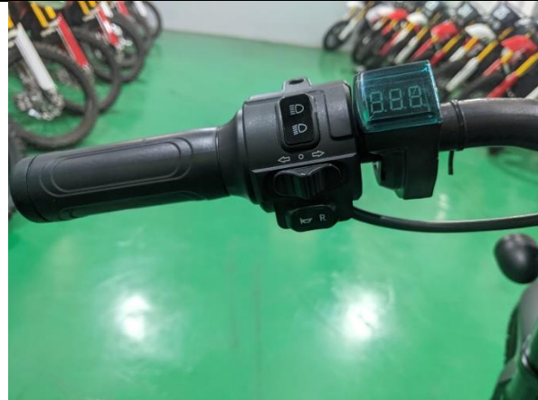
Volt meter, terletak pada stang bagian kiri juga terdapat saklar lampu utama, saklar reteng dan bel
