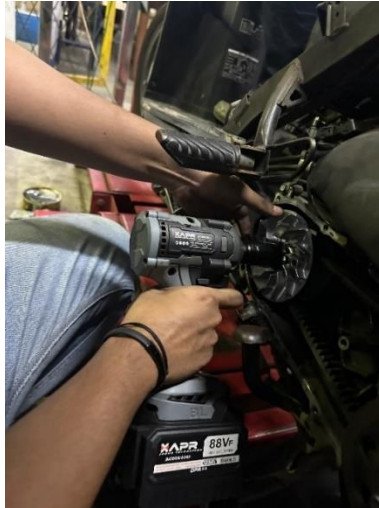
Gambar 3. 4 Proses Pemasangan Pulley
